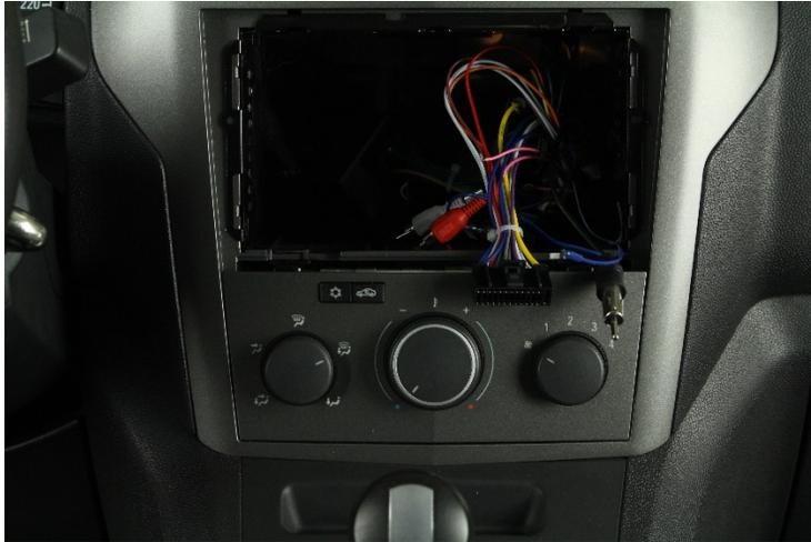
6. Verbinden Sie das jeweilige Hauptanschlusskabel (Nr. 11) des Radical-Geräts (Nr. 1) mit dem Stecker des Fahrzeugs und schliessen Sie den Verriegelungsmechanismus des Steckers. Verbinden Sie anschliessend das CAN-Bus Interface (Nr. 12) mit dem Hauptanschlusskabel. Verbinden Sie alle zuvor in den Radioschacht verlegten Kabel und die originalen Antennenkabel mit dem Radical-Gerät (Nr. 1).
