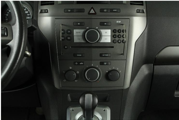
1. Lösen Sie mit dem beiliegenden Entriegelungswerkzeug (Nr. 14) Ihr Werksradio aus dem Radioschacht. Hierzu müssen die zwei Entriegelungsschlüssel eingeführt werden.
