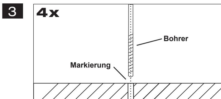
Legen Sie dann den Verstärker beiseite und bohren dann die Löcher für die Fixierschrauben an den zuvor markierten Punkten. Vergewissern Sie sich zuvor, dass keine Kabel, Leitungen und andere Komponenten des Fahrzeugs beim Bohren beschädigt werden. Alternativ können Sie auch (je nach Untergrund) selbstschneidende Gewindeschrauben verwenden.
