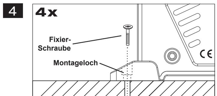
Halten Sie dann den Verstärker wieder an die zuvor gewählte Position und verschrauben Sie den Verstärker mit geeigneten Schrauben an den zuvor gebohrten Bohrlochern mit dem Fahrzeug.
