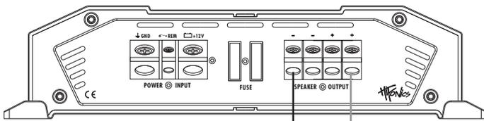
⚠ Optional kann noch ein zweiter Subwoofer an die nicht belegten Anschlussklemmen angeschlossen werden. Dann muss die Impedanz pro Subwoofer 4 - 8 Ohm betragen.
