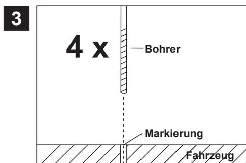
Legen Sie dann den Verstärker beiseite und bohren dann die Löcher für die Fixierschrauben an den zuvor markierten Stellen und vergewissern Sie sich zuvor, dass keine Kabel, Leitungen und andere Komponenten des Fahrzeugs beim Bohren beschädigt werden. Alternativ können Sie auch (je nach Untergrund) selbstschneidende Gewindeschrauben verwenden.
