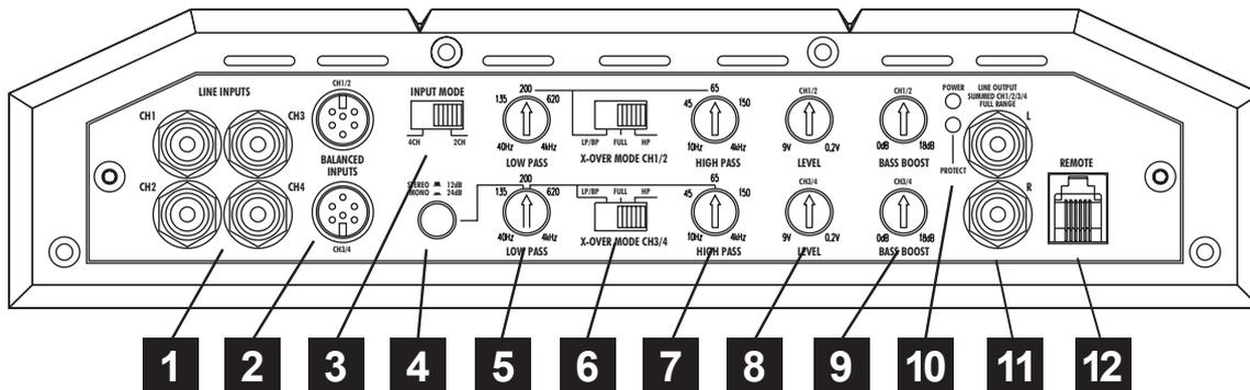
**1** Die **LINE INPUT-Cincheingänge** zur Ansteuerung mittels Cinch-Kabel mit dem Steuergerät verbinden. Werden nur die Kanäle 1 und 2 belegt, sollte sich der **INPUT MODE**-Schalter in der **Schalterstellung 2CH** befinden.
