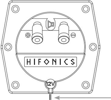
Für die +12V Stromversorgung der LED-Beleuchtung verwenden Sie bitte das am Terminal befestigte Kabel und schließen Sie dieses entsprechend an. Bitte achten Sie auf die korrekte Polarität.
